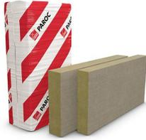
Homogene, nichtbrennbare Putzträgerplatte aus Steinwolle mit hervorragenden Wärmedämmeigenschaften, Festigkeiten und Dübelzahlen. Wasserabweisend, dampfdurchlässig, alkalibeständig, formstabil und alterungsbeständig. Faserorientierung parallel zur Wandoberfläche. Mit beidseitiger Vorbeschichtung.
